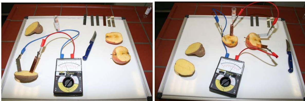
Abb.: Zwei verschiedene Lösungsvorschläge: „Obstbatterie“ mit Kartoffel, Zinkblech und Kupferblech (links); sowie Reihenschaltung zweier Batterien mit Apfelhälften (rechts). Die Pole sind richtig geschaltet. Die hohe Spannung bei Verwendung von Zinkblech wurde erkannt. Die Addition der beiden Einzelspannungen bei Reihenschaltung (rechts) war hier eine zusätzliche Erkenntnis.
