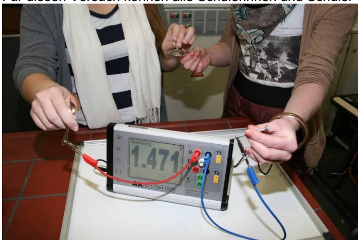
Abb. 3 (unten): Mit einem zweiten Silberlöffel und einer zweiten verzinkten Schraube ergibt sich – richtig gehalten – die Addition zweier Einzelspannungen. Dies entspricht zwei in Reihe geschalteten galvanischen Zellen.
