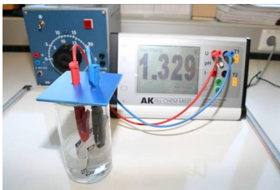
Abb.: Bestimmung der Zellspannung einer LowCost-Brennstoffzelle nach elektrolytischem Beladen der Elektroden mit Wasserstoff und Sauerstoff.
