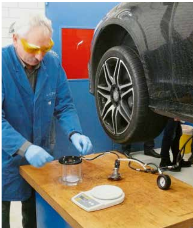
Ein Teilnehmer experimentiert an einer Versuchsanordnung am Fahrzeug zur Strahlbild- und Mengenkontrolle bei AdBlue-Zusatz.
